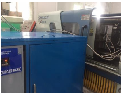
Hình 3.4 Hệ thống điều khiển nhiệt độ kết nối với khuôn trên máy SW 120B
